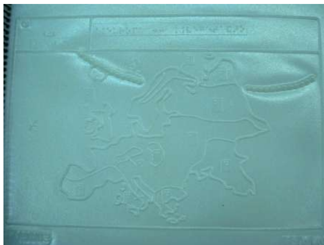
Figura 3 – Alguns símbolos padrão para mapas táteis em escala pequena e um exemplo de mapa tátil em acetato. Fonte: LabTATE (2008)
