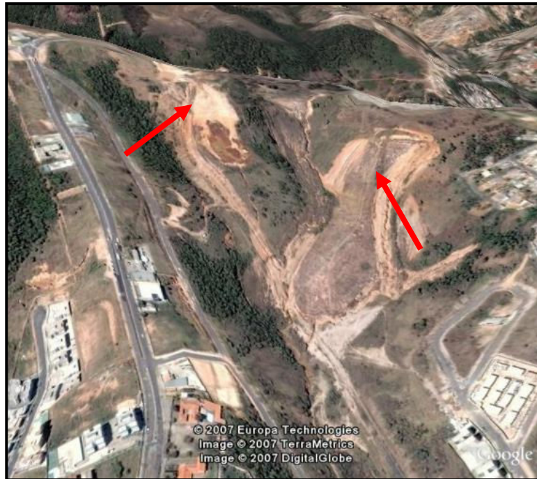
Figura 2: Visão oblíqua de erosão provocada pela ocupação humana, parque industrial da cidade de Belo Horizonte.
